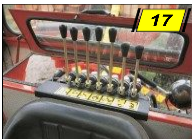
Eine übliche Ventilblockmontage am Traktor.
