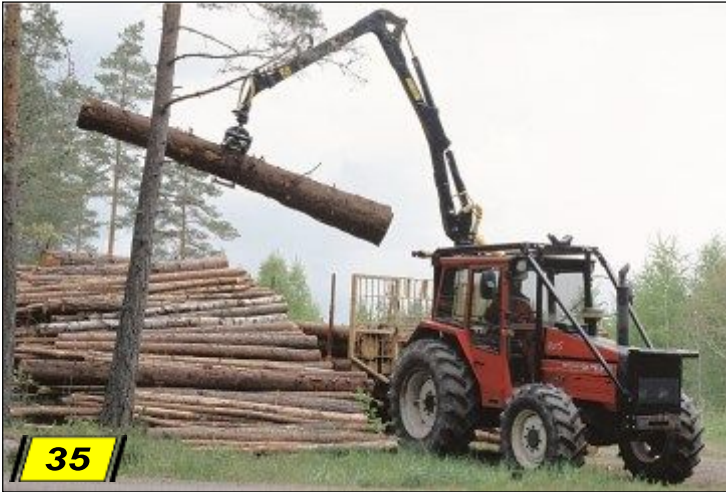
Ein auf einem Valtra montierter K.T.S 7,5 m-Kran. Die Montage wurde bei K.T.S in Kumla, Schweden, ausgeführt.
