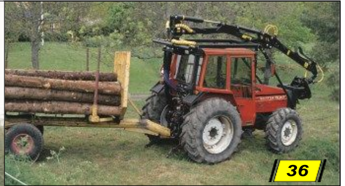
Ein auf einem Valtra montierter K.T.S 7,5 m-Kran. Die Montage wurde bei K.T.S in Kumla, Schweden, ausgeführt.
