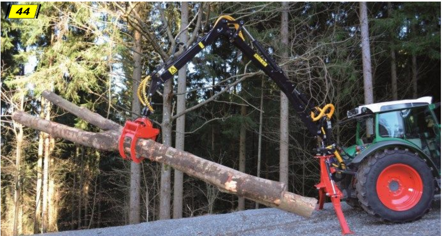
K.T.S Hydraulikkran mit hydraulischen klappbaren Stützbeinen, die am Dreipunktheber des Traktors montiert sind. K.T.S Hydraulikkran 6,4 m.
