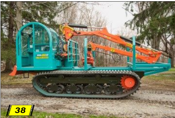
Ein auf einem Skidder von EnviroMax montierter K.T.S 6,7 m-Kran.
